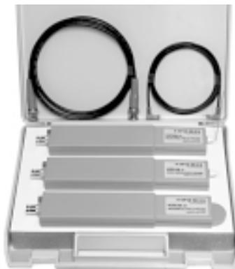
garantizan un nivel de ruido bajo, una amplificación elevada y alta sensibilidad. La conexión de las sondas al analizador de espectros, receptor de medida u osciloscopio se realiza mediante un cable coaxial BNC de 1,5m de longitud. Los preamplificadores incorporados en las sondas (aprox. 30 dB) hacen innecesario la utilización adicional de aparatos externos, hecho que facilita el manejo considerablemente.
